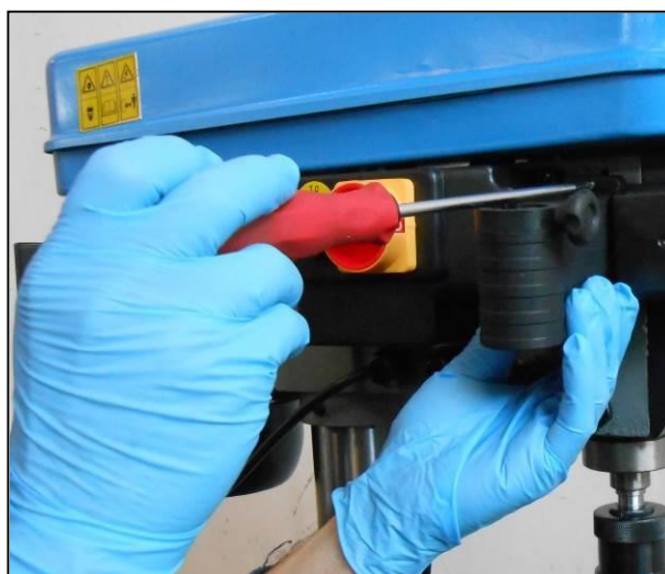
Фигура 11 – Сглобяване на блокировката с микропрекъсвач
