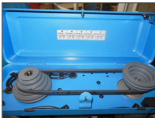
Фигура 35 – Предпазен капак на ремъчните шайби с микропрекъсвач
