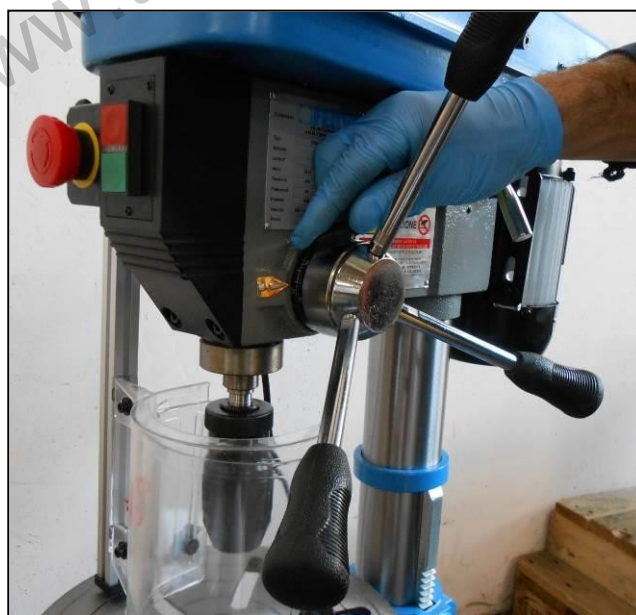
Фигура 32 – Настройване дълбочина на пробиване
