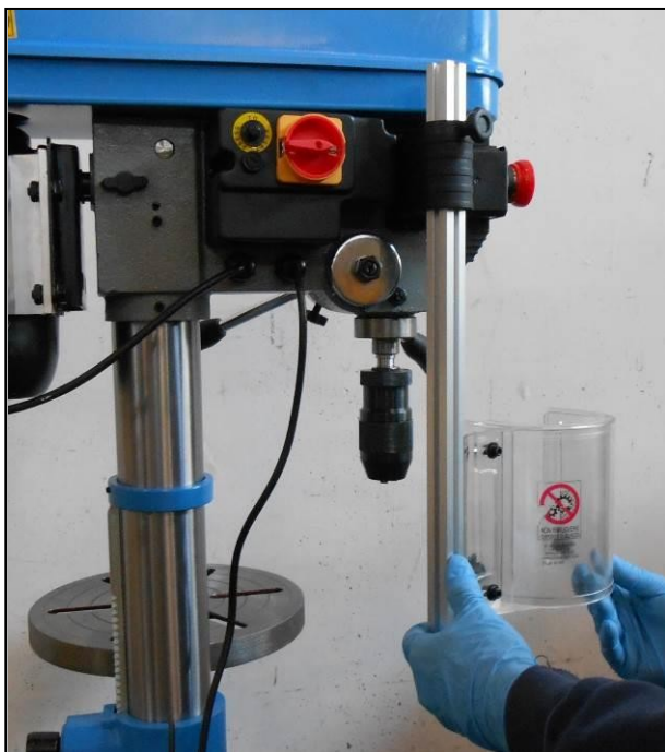
Фигура 17 – Вмъкване на рамото и правилно разполагане на предпазния екран
