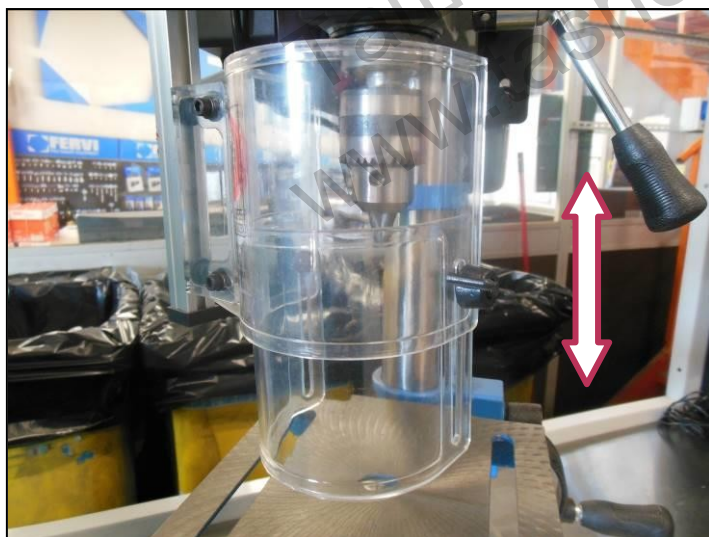
Фигура 18 – Приплъзване на предпазния екран по вертикала и по хоризонтала
