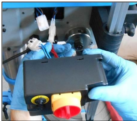
Фигура 7 – Етапи на монтаж на електрическото табло
