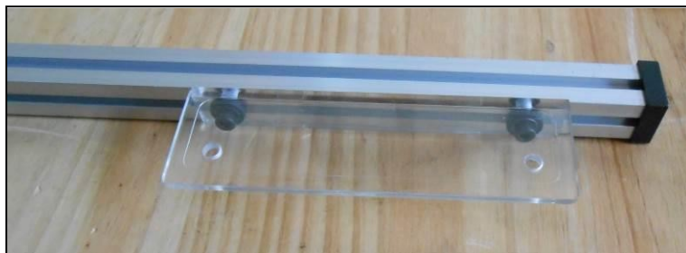
Фигура 14 – Изглед на рамото за захващане, към което е сглобена свързващата част
