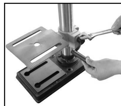
Фигура 4 – Монтаж на плота
